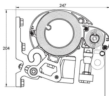
Vue en coupe avec lambrequin enroulable Sun'System manuel
